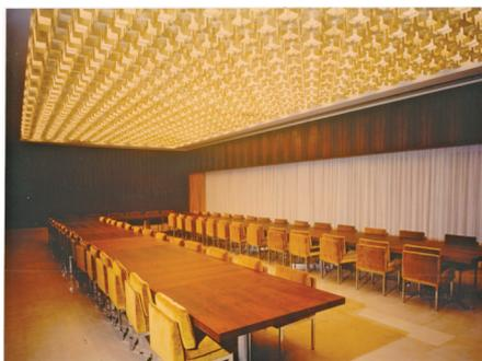
Vues d'ensemble et détail du plafond de 93m2 en aluminium oxydé – Nouvelle préfecture de Valence
